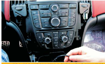
37 固定原车面板四颗固定螺钉，把空调调节轮上的挡片复位
