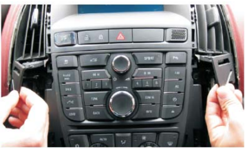
09 轻轻打开空调调节轮两处挡片，露出内部两颗内部面板固定螺钉
