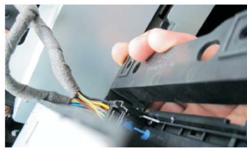
32 连接原车一键启动等按钮插头
