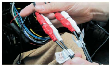
28 将AV线束上的RCA母头与电源线上的RCA公头连接(注意标签内容及颜色)
