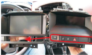
17 将导航面壳上配送的假按键取下，把原车三个按钮安装到导航面壳上
