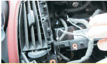
19 将电源线上有LIN标签的线穿过原车支撑骨,并将插头与原车连接屏LCD的公插对应插好
