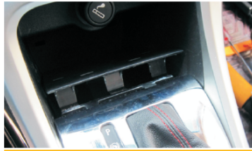
05 用撬刀撬松并取下储物盒下部支撑板
