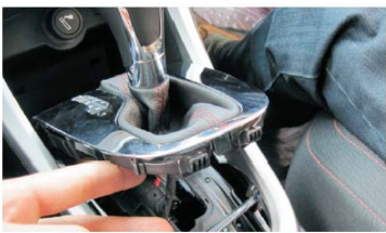
07 用十字螺丝批取下面板装饰件两颗安装螺钉（档位装饰面板下，左右各一颗）
