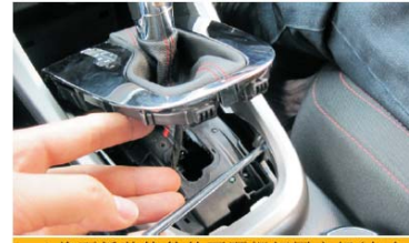
39 将面板装饰件的两颗螺钉固定好(左右各一颗)
