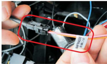
26 将开门报警器放在副驾驶位储物盒上部并固定好,连接报警喇叭母头与解码盒端公头
