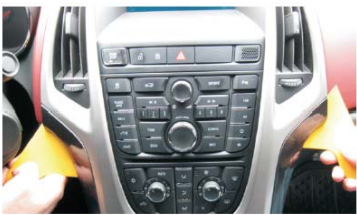
08 用撬刀撬松并取下面板装饰件，注意内部卡扣
