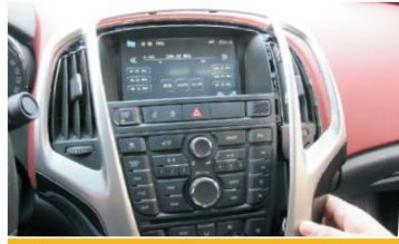
38 把面板装饰件装配到位，注意内部扣位扣好
